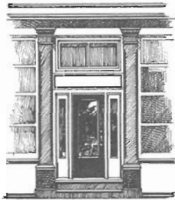
Des pilastres plats rehaussent l'entrée de ce bâtiment d'inspiration néo-classique.
