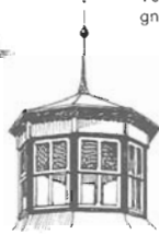
Les coupoles rondes, carrées ou polygonales qui couronnent les granges procurent lumière et aération.
