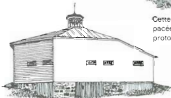
Une coupole centrale coiffe une charpente de grange polygonale érigée sur des fondations en pierres.
